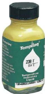
Средство для быстрого и надежного определения температуры поверхности с точностью до  $\pm 1\%$  от номинальной. Используется для измерения рабочих температур в динамических условиях, при термическом картировании поверхностей, калибровке дисковых тормозных механизмов, формовании пластиковых ламинатов, отжиге полированных металлов, калибровке промышленных печей и т.д. Легко наносится и быстро сохнет. Не воспламеняется. Экологически безопасно.
