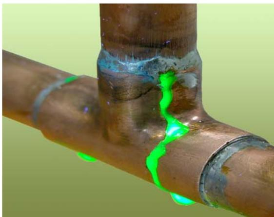
Регистрация утечки в системе охлаждения с помощью флуоресцентного концентрата
