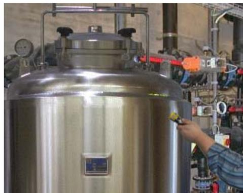
*Регистрация разгерметизации резервуара с помощью флуоресцентного концентрата Н 849*
