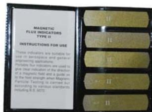
Индикаторы Burmah-Castrol представляют собой тонкие гибкие металлические полоски размером 50x12x0,15 мм. Индикаторы состоят из трех слоев, каждый толщиной 0,05 мм. Средний слой выполнен из никель-железного сплава с высокой относительной магнитной проницаемостью. Наружные слои выполнены из немагнитного материала. Средний слой имеет три продольных параллельно расположенных шлица длиной 42 мм.
