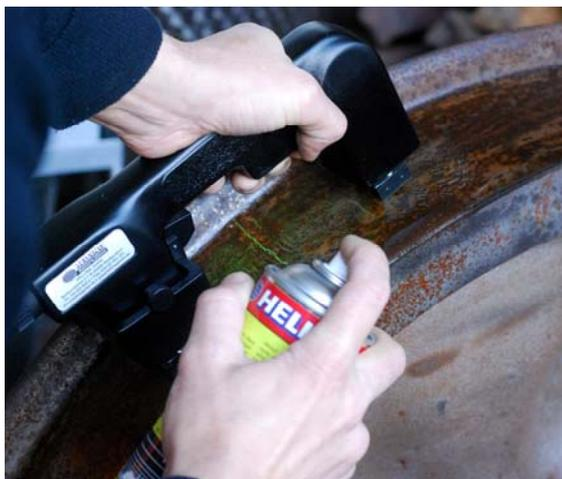
Электромагниты серии HANSA имеют литой ударопрочный пластиковый корпус и соответствуют классу защиты IP65; поставляются для работы от сети переменного тока 230 В или с электропитанием 42В от дополнительного трансформатора. Они могут использоваться при максимальном времени включения 150 сек и максимальной относительной продолжительности включения (ОПВ) 50%, за исключением UM8 (60 сек/30% ОПВ). Электромагниты оснащены съемным кабелем во избежание его перегибов и изломов в месте соединения.
