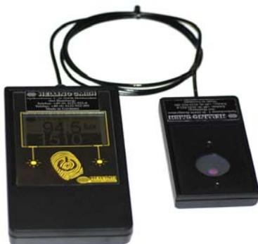
Настоящий прибор является комбинированным прибором, который позволяет с помощью одного сенсора одновременно измерять освещенность в видимой области (лк) и энергетическую освещенность в УФ-области спектра.
