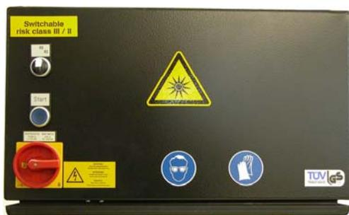
Светильник имеет стальной корпус, в котором размещены все электрические компоненты – пускорегулирующий аппарат, следящее реле, сетевой выключатель, предохранители, устройство контроля температуры, вентилятор, клеммная колодка и алюминиевый корпус для УФ излучателя 400 Вт. Сетевое подключение осуществляется через кабель Ölflex 540 P.
