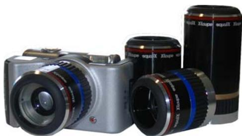
X-Loupe™ является переносной цифровой фотокамерой-микроскопом и состоит из модифицированной камеры Canon IXUS 950is, модуля микроскопа и сменных объективов.
