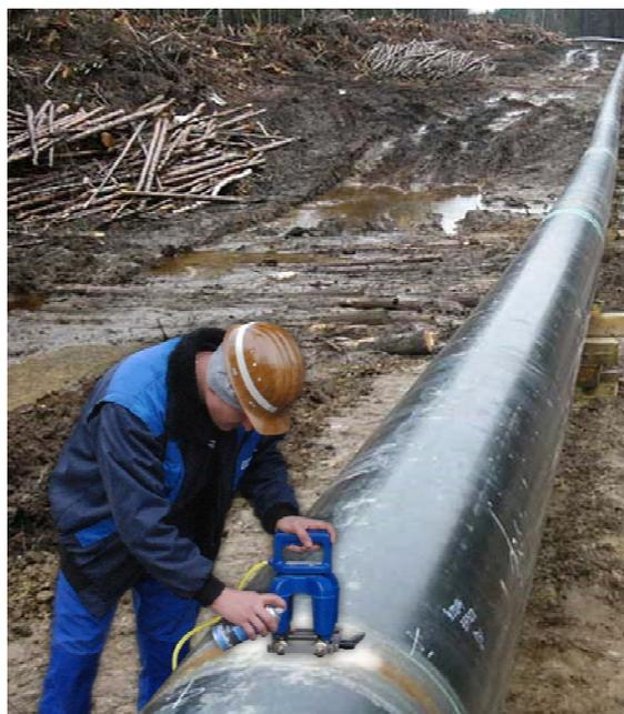
На проверяемую деталь магнитное поле прикладывают через небольшой воздушный зазор. Для этого 4 полюса электромагнита снабжены регулируемыми опорными колесами. Они обеспечивают постоянный воздушный зазор между полюсами и поверхностью проверяемой детали и, кроме того, позволяют легко передвигать электромагнит вдоль проверяемого участка.
