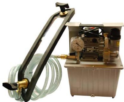
Вакуумный насос EV 20 N для создания градиента давления в сочетании с вакуумными рамками различной конфигурации и пенопластовым индикатором используется при проведении контроля герметичности сварных швов резервуаров, цистерн, трубопроводов, а также для исследования литых деталей на предмет наличия пор.
