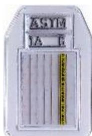
Проволочные эталоны чувствительности (качества изображения) – пенетрометры по стандарту ASTM/ASME представляют собой 6 проволок различного диаметра из железа, алюминия, меди или титана, закрепленных в прозрачном пластике.
