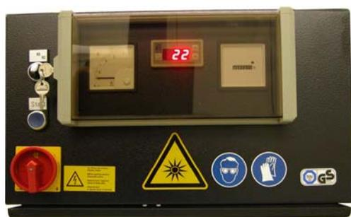
В стальном корпусе светильника класса IP 54 интегрированы все электрические компоненты – пускорегулирующий аппарат, следящее реле, амперметр, счетчик рабочего времени, сетевой выключатель, предохранители, устройство контроля температуры с дисплеем, вентилятор, клеммная колодка и алюминиевый корпус для УФ излучателя 400 Вт. Сетевое подключение осуществляется через кабель Ölflex 540 P.
