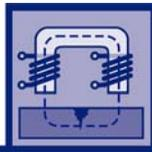
Магнитопорошковый метод - один из самых чувствительных, надёжных и производительных методов неразрушающего контроля поверхностей изделий из ферромагнитных материалов в их производстве и эксплуатации. Магнитопорошковый метод основан на притяжении магнитных частиц силами неоднородных магнитных полей, возникающих над дефектами. Метод магнитопорошкового контроля (МК) предназначен
